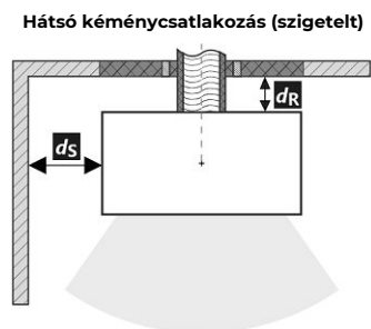
A füstcső áthaladása éghető anyagból készült falon
