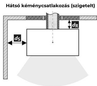
A füstcső áthaladása éghető anyagból készült falon
