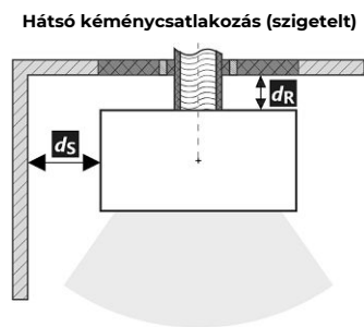
A füstcső áthaladása éghető anyagból készült falon
