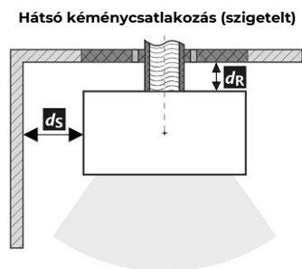
A füstcső áthaladása éghető anyagból készült falon
