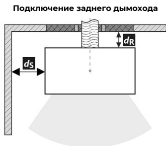
Проход дымовой трубы через стену из горючего материала
